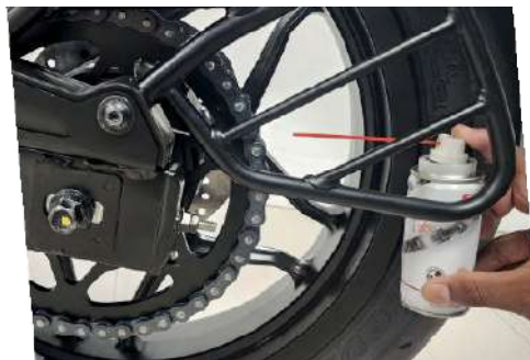
Limpieza de la cadena de transmisión
