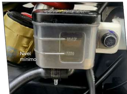
Depósito de líquido de frenos trasero
