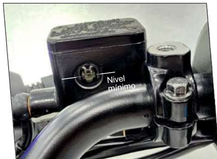
Depósito de líquido de frenos delantero
