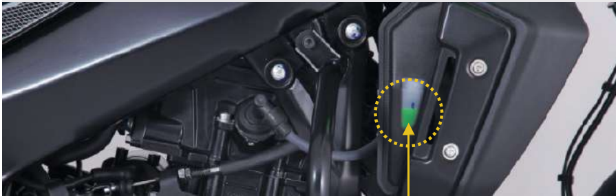
Tanque de expansión de refrigerante
